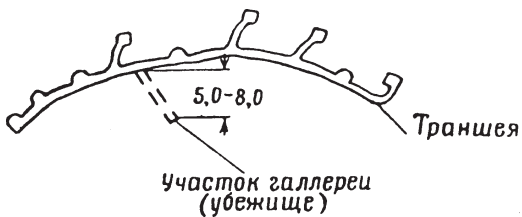
Участок галереи, примыкающий к траншее
